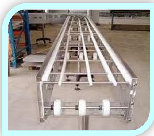
โครงสร้างระบบสายพาน Modular แบบตรง (Straight)
