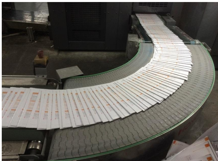
โค้ง 90 องศา ลำเลียงหนังสือพิมพ์ในอุตสาหกรรมการพิมพ์
