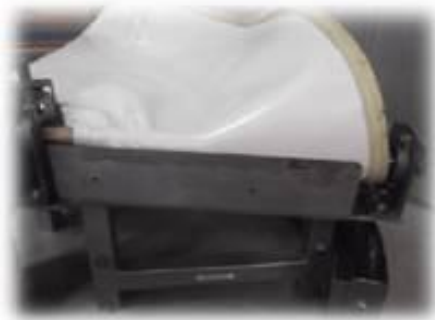
สายพานบิดตัว-เสียรูป
