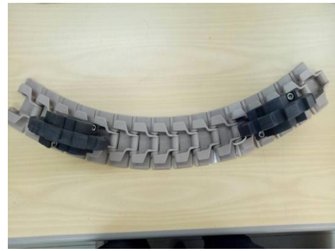
รูปลักษณะการจับหัว-ท้าย สายพานแบบปกติ
