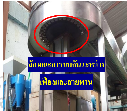
เฟืองที่ผลิตขึ้นเพื่อใช้จับสายพานด้านข้าง
