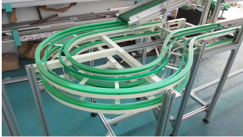
ตัวอย่างโครงสร้างสายพานโค้งรุ่น 500 B ที่ทำเสร็จเรียบร้อยแล้ว
