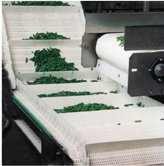
ติด Cleat + Side Guard เพื่อป้องกันวัสดุตกหล่นด้านข้าง
